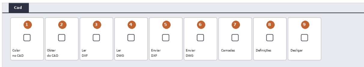
Friso Cad — acções disponíveis quando o AutoCAD está ligado
