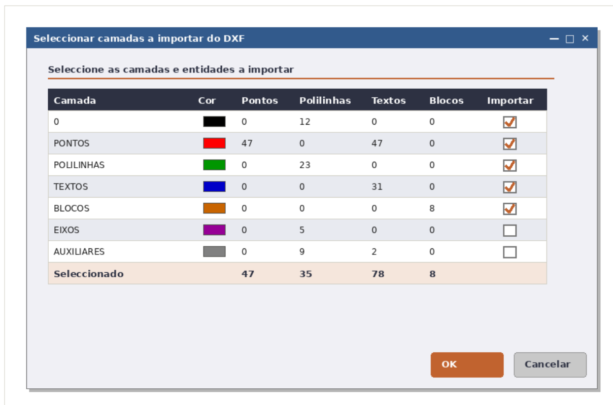
Janela de selecção de camadas ao importar um ficheiro DXF
