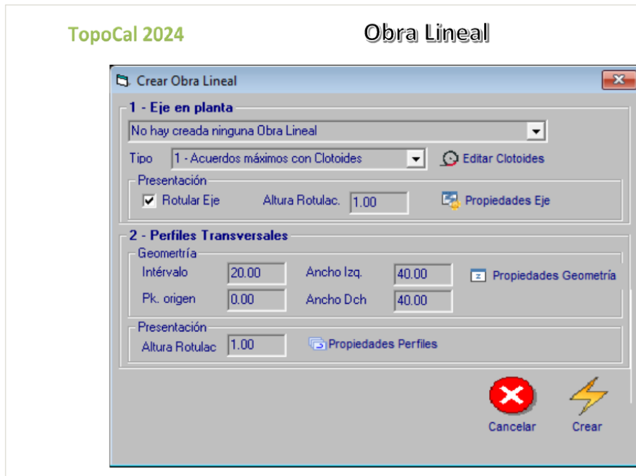
Diálogo principal "Crear Obra Lineal". Se divide en dos bloques: (1) Eje en Planta y (2) Perfiles Transversales, con botones de propiedades para configurar cada parte por separado.
