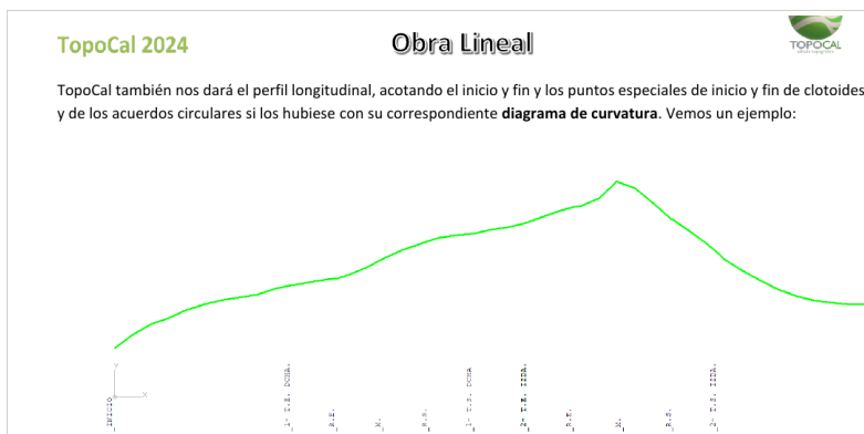
Perfil longitudinal del terreno con diagrama de curvatura inferior. Se marcan Inicio, C.E. (Clotoide Entrada), R.E. (Radio Entrada), M (Punto Medio), R.S. (Radio Salida), C.S. (Clotoide Salida) y Fin.
