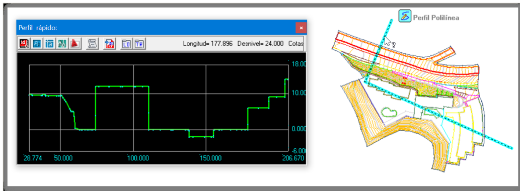
Guitarra longitudinal — cota terreno, distancia al origen y distancia parcial por vértice
