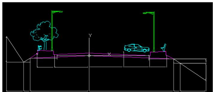
Tal como se ha dicho con las aplicaciones CAD que se pueden comunicar con TopoCal, al importar cualquier dibujo DXF también se incluyen automáticamente los bloques que tenga, tal como se explicó anteriormente:
