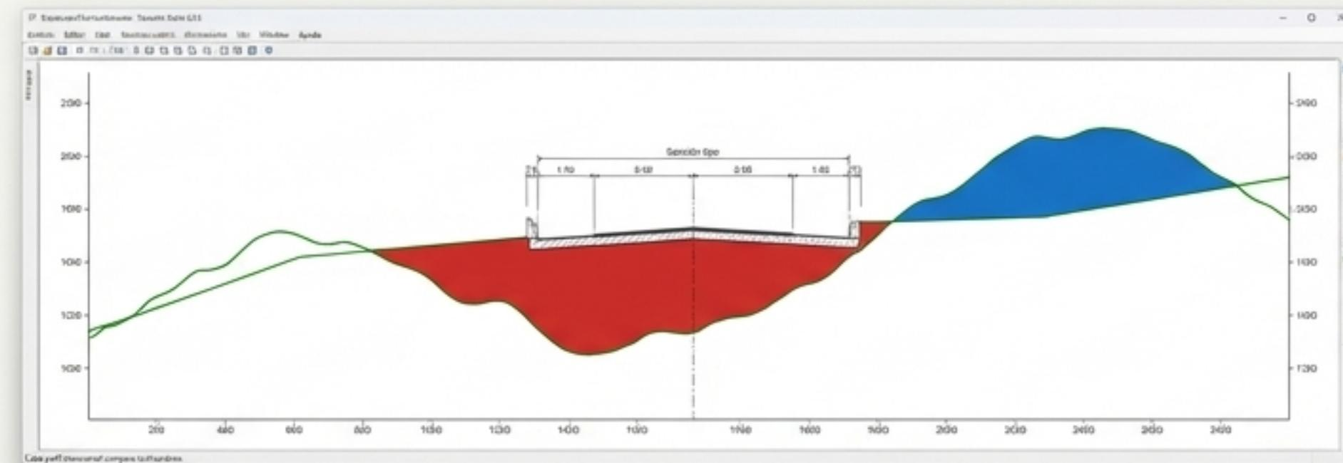
Cada perfil transversal compara la línea del terreno original con la sección del proyecto diseñado. TopoCal aplica un código de colores estándar para una interpretación inmediata del movimiento de tierras.
